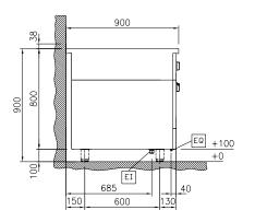
Electrical inlet (power) EQ **Equipotential screw**
